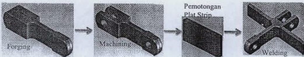
Gambar 23. Proses umum pembuatan scraper chain
